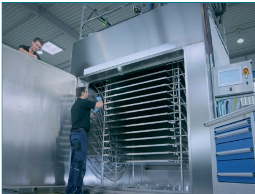
Двухуровневый производственный участок позволяет конструировать и тестировать сублимационные сушилки прямо на площадке Optima Pharma. На выставке АСНEMA компания представит новую гибкую и компактную сублимационную сушилку CS
