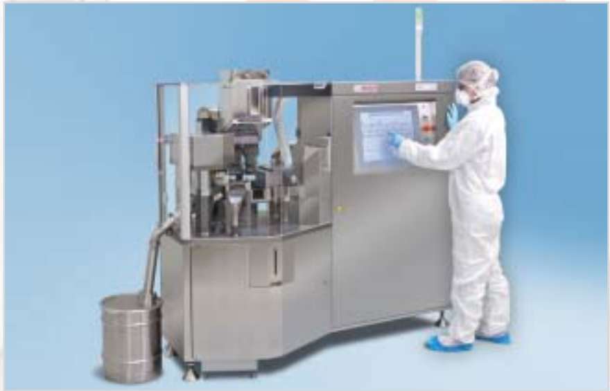
Аппарат KKH 3900 производства компании Bosch одновременно контролирует несколько качественных параметров процесса, таких как масса, размер и положение заполненной капсулы
