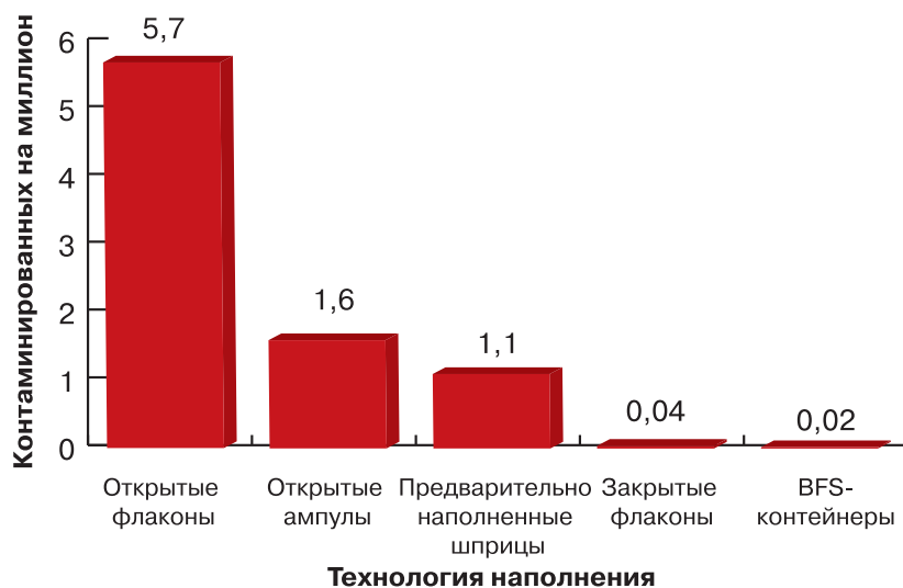
Рисунок. Количество контаминированных на 1 миллион наполненных контейнеров при предположительном наличии 1 КОЕ в 5000 м 3 воздуха
