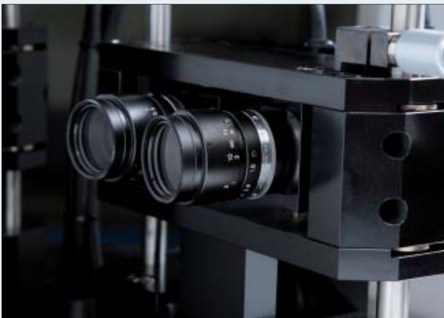
Рис. 3. Инспекция на наличие косметических дефектов с использованием ультрасовременных камер
