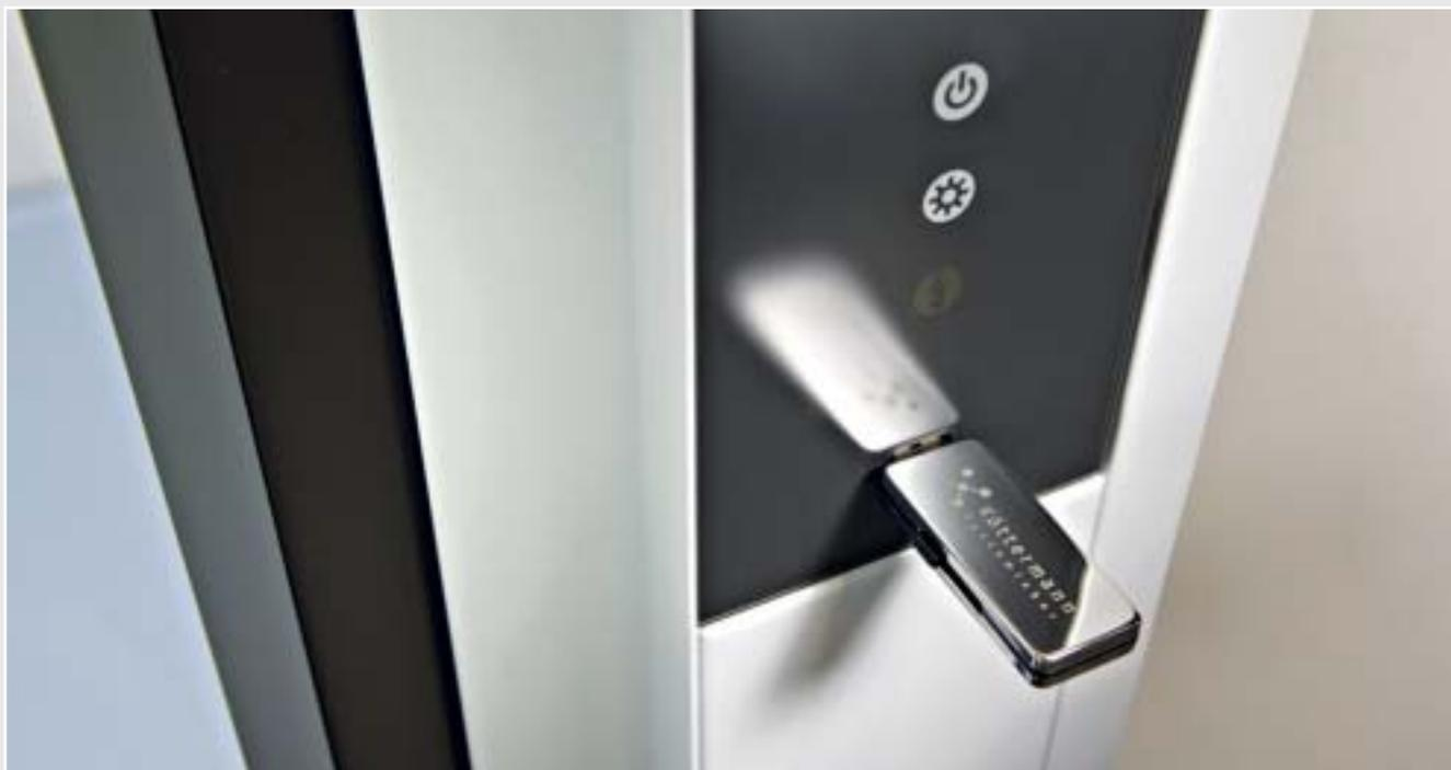
Рис. 2. Встроенный USB-интерфейс для считывания или измерения параметров
