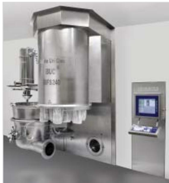
Рис. 1. Аппарат с псевдооживленным слоем Bohle BFS 240 с HMI
