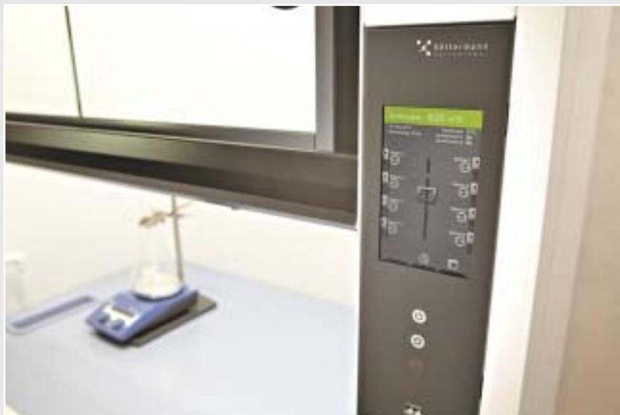
Рис. 1. Вытяжные шкафы Exploris Variotop с регулируемыми по высоте столешницами не только для эргономики пространства; для опытов на дополнительной выдвигаемой поверхности настольный вытяжной шкаф может быть преобразован в вытяжной шкаф с внутренним пространством увеличенной высоты
