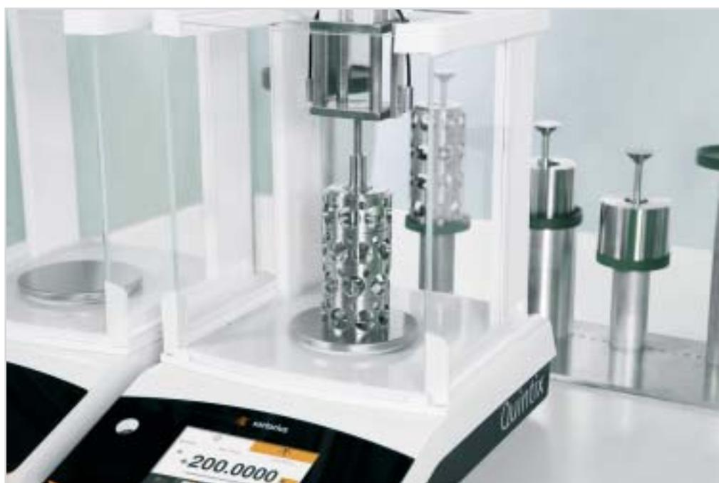
т.п. Для получения надежных результатов взвешивания необходимо, чтобы весы были откалиброваны – именно поэтому в комплект поставки каждой весов Practum® входит высококачественная внешняя калибровочная гиря с сертификатом калибровки. Современные и высокотехнологичные весы Sartorius Practum® разработаны и произведены в Германии и характеризуются высоким уровнем воспроизводимости и точности измерений. ■
