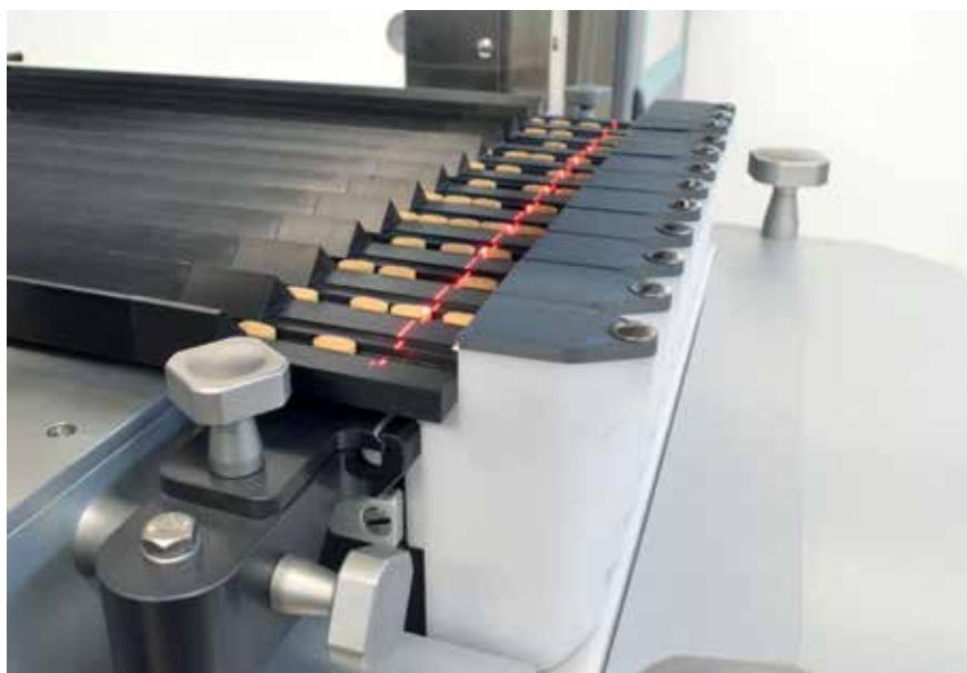
Новая технология Valida , разработанная Marchesini Group с целью верифицировать целостность каждой таблетки с гарантированной отбраковкой до попадания таблетки в блистер
