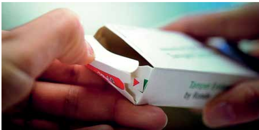
В качестве защиты от фальсификации продукции используются выступы и пазы на складной коробке, которые позволяют определить, была ли вскрыта упаковка (фото компании Rondo / Medipak Systems)
