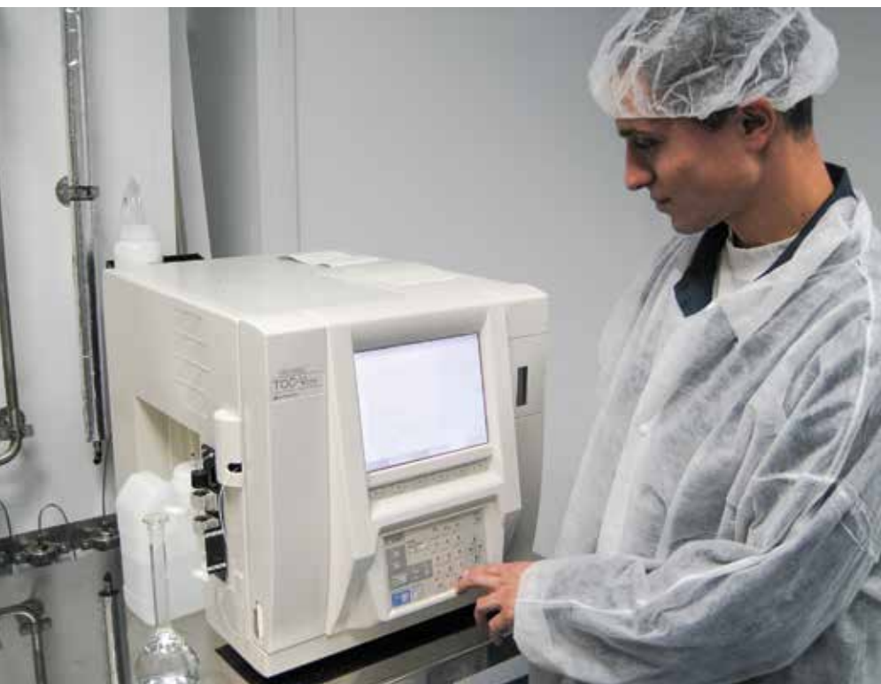
Фото № 2. Выполнение измерений на TOC-анализаторе модели ON-LINE TOC-V CSH производства корпорации SHIMADZU в лаборатории фармацевтического предприятия «Киевмедпрепарат»
