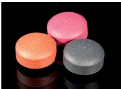
Рис. 4. Таблетки, покрытые при температуре продукта 33 °С оболочкой, содержащей 15 % ПЭГ 6000
