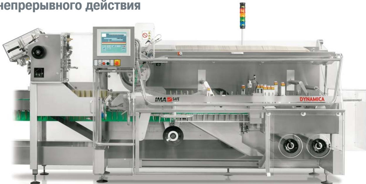
**Картонная машина непрерывного действия DYNAMICA является завершающей моделью ряда отдельно стоящих горизонтальных картонных машин непрерывного действия IMA Safe, производительность которой составляет 400 упаковок в 1 мин. Все три предлагаемые модели машины DYNAMICA предназначены для работы с широким ассортиментом размеров упаковки и продуктов**
