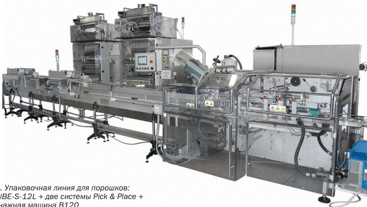
Рис. 2. Упаковочная линия для порошков: две TUBE-S-12L + две системы Pick & Place + картонная машина B120
