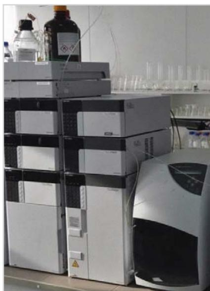
Фото № 4. Жидкостный хроматограф SHIMADZU модели LC-20A с детектором по светорассеянию ELSD-LT II
