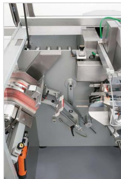
Узел захвата коробки машины X1
