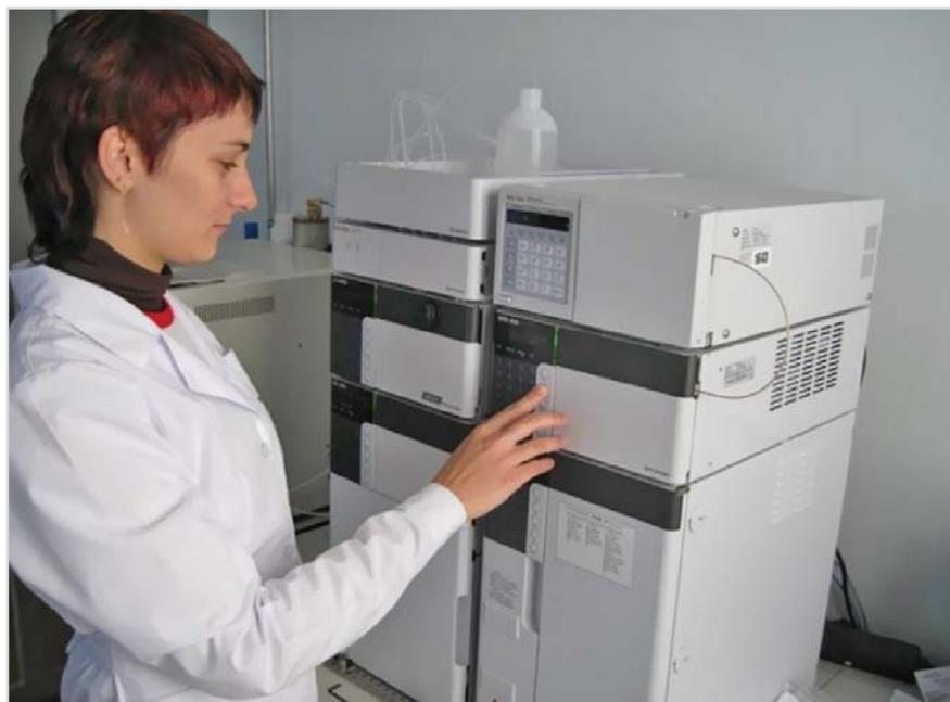
Фото № 1. Измерения на жидкостном хроматографе SHIMADZU модели LC-20A с рефрактометрическим детектором RID-10A в лаборатории фармацевтического предприятия «НИКО»
