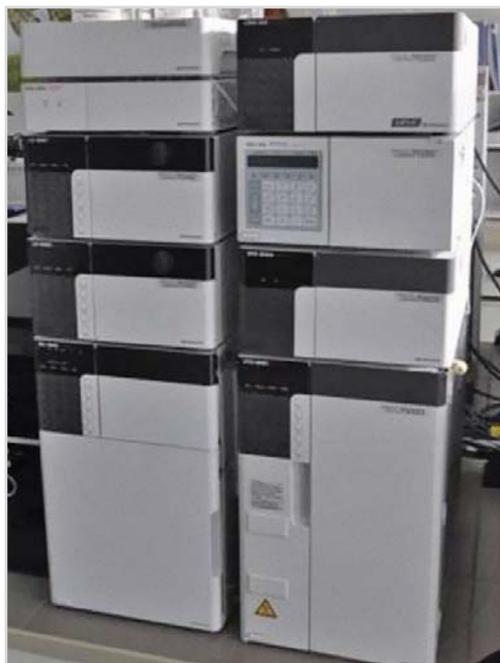
Фото № 2. Жидкостный хроматограф SHIMADZU модели LC-20A с кондуктометрическим детектором CDD-10AVP
