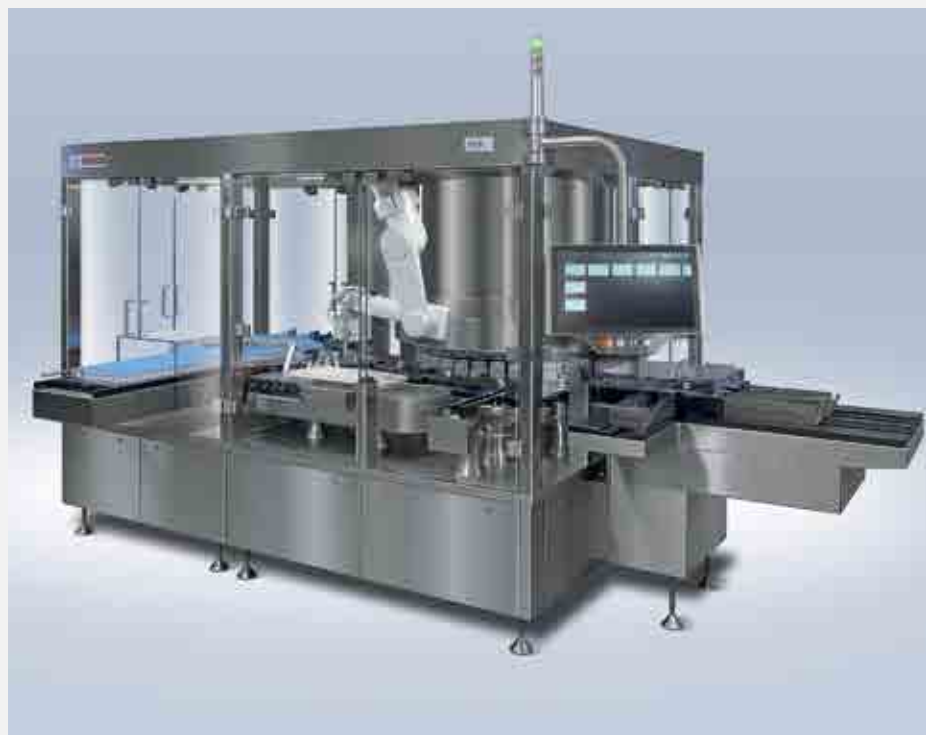
Машина новой серии KLV 1360 для контроля герметичности флаконов под вакуумом
