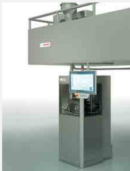
Эффективное таблетирование на таблет-прессе платформы Xelum
