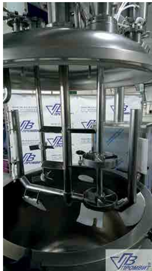
Мешалки реактора: якорная и две турбинные
