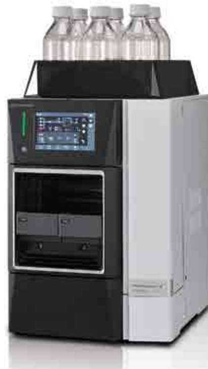
Фото № 3. Жидкостный хроматограф модели LC-2030 производства SHIMADZU
