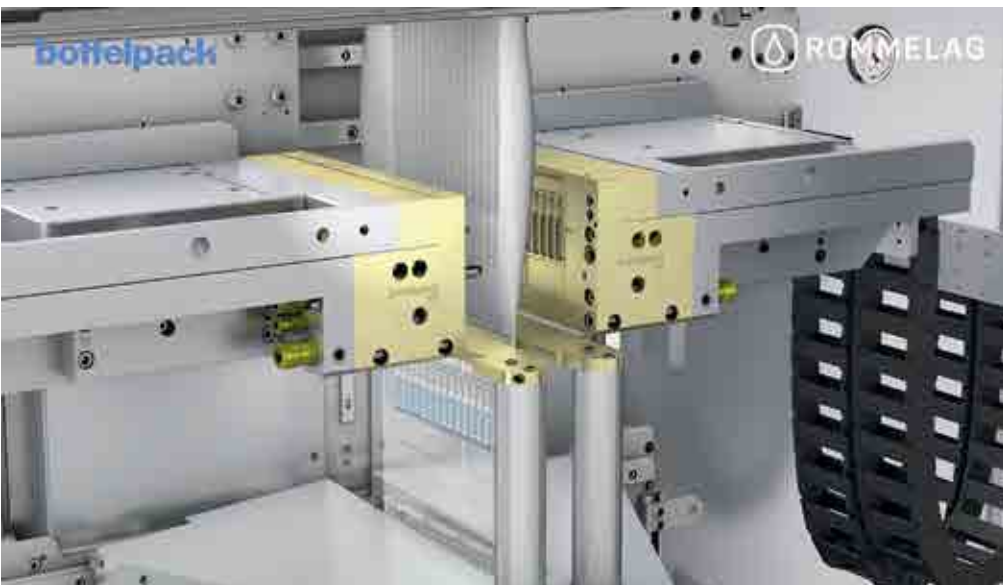
Технологический процесс «выдув – наполнение – запайка» с одной формой и закрытым рукавом
