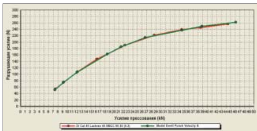
Рис. 9. Сравнение профилей прессования таблеток на 1-станционном таблетировочном прессе [1] и 19-станционном таблетировочном прессе [2] при идентичной скорости загрузки. Машина производит таблетки одинаковой твердости
