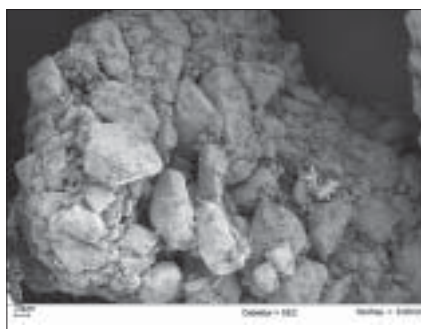
Рис. 4. СЭМ изображение агломерата лактозы (произведенный при температуре воздуха на входе 60 °C), ПВП К90 использовался в качестве связующего
