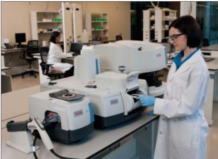
Рис. 3. ИК-Фурье спектрометр Nicolet iS50, оснащенный различными модулями
