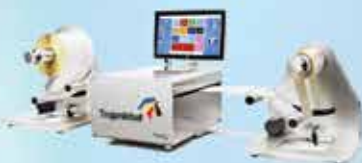
Настільна міні-типографія TrojanOne (Данія) дозволяє наносити повнокольоровий друк з розширенням 1600 dpi та швидкістю до 300 мм/сек та є ідеальним рішенням для друку кольорових етикеток в кількості від 1 і до "на вимогу"
