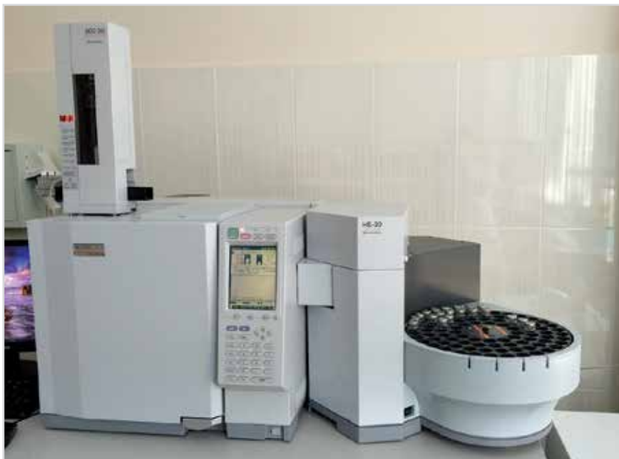
Фото № 3. Газовый хроматограф SHIMADZU модели GC-2010Plus с автоинжектором жидких проб AOC-20i и автоинжектором равновесной паровой фазы HS-20
