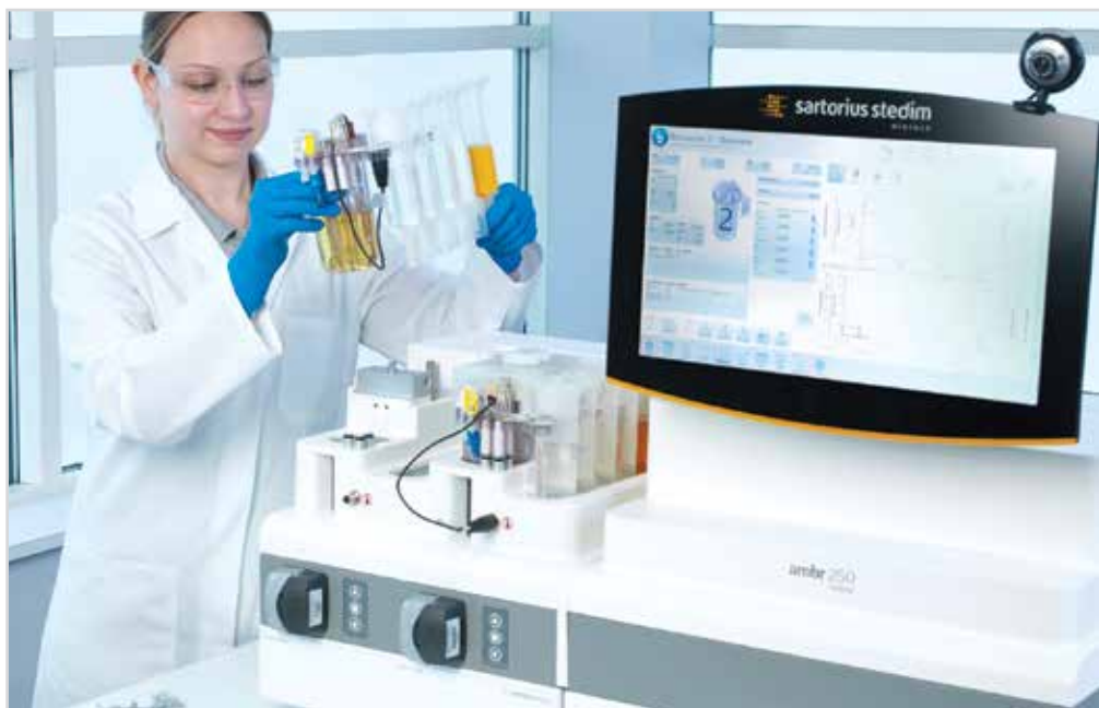
Рис. 2. Общий вид модульного биореактора ambr® 250 modular
