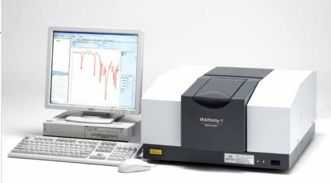
Фото № 5. Спектрофотометр ИК-диапазона с преобразованием Фурье SHIMADZU модели IRAffinity-1
