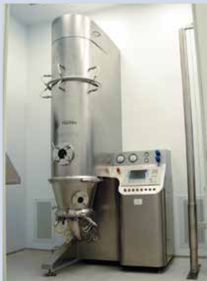
Гранулятор псевдооживленного слоя Unilab 30 производства компании Huettlin
