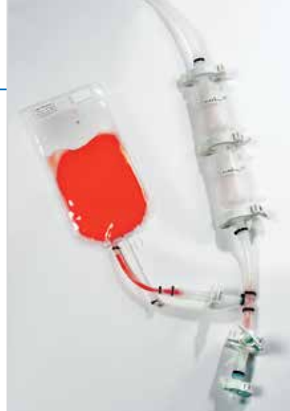
Рис. 1. Стерильный дисконнектор Kleenpak™ состоит из штекерного разъема (вставной узел) и втулки (охватывающий узел), которые после активации внутреннего поршня и короткого вращательного движения легко, безопасно и быстро могут быть отделены друг от друга
