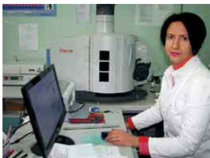
Рис. 1. Старший научный сотрудник отдела аналитической химии, канд. хим. наук Брылева Е.Ю. за работой на атомно-эмиссионном спектрометре с индуктивно-связанной плазмой Thermo Scientific iCAP 6300 Duo
