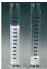
Рис. 2. Сравнение объемов равных массовых количеств AEROSIL® 200 Pharma (слева) и AEROPERL® 300 Pharma (справа)
