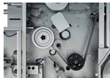
Ролик запайки с сервоприводом позволяет достичь отличных результатов запайки блистера
