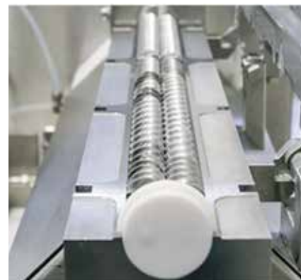
Открытый корпус с фронтальным видом на шнеки, которые являются центральной частью и зоной обработки гранулятора VCG 25
