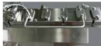
Закрытый корпус гранулятора VCG 25, имеющий гибкие вставляемые порты и зону добавления жидкости
