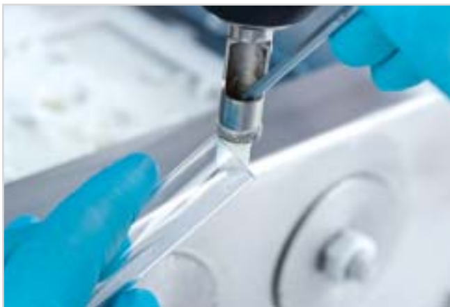
Отбор пробы из установки ZETA LabFreeze Container
