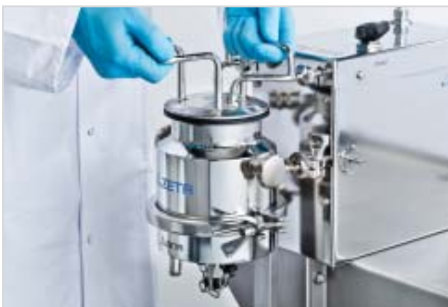
Установка ZETA PilotFreeze Container с замороженным ледяным блоком
