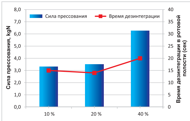
Рис. 2. Зависимость времени дезинтеграции в полости рта от силы прессования таблеток диаметром 8 мм с F-MELT® типа М. При добавлении 40 % ацетаминофена твердость таблетки составляет 30N
