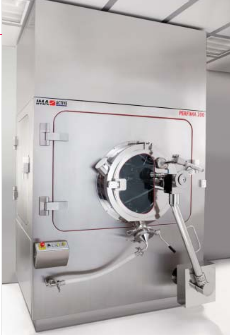
Перфорированный барабан для нанесения покрытия на таблетки Perfima 200, установленный через стену
