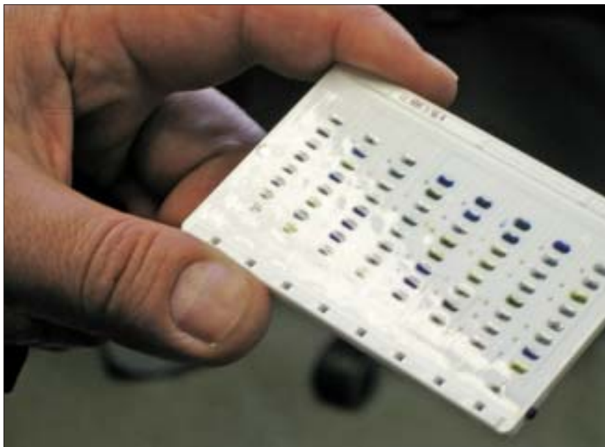
Фото № 2. Планшет для проб к MALDI-TOF масс-спектрометру SHIMADZU серии AXIMA
