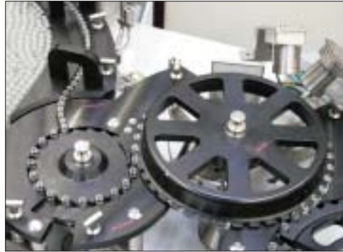
groninger UFV: транспортная и проверочная станция
