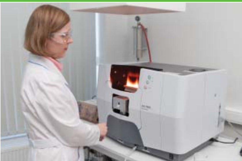
Атомно-абсорбционный спектрофотометр Shimadzu, Япония
