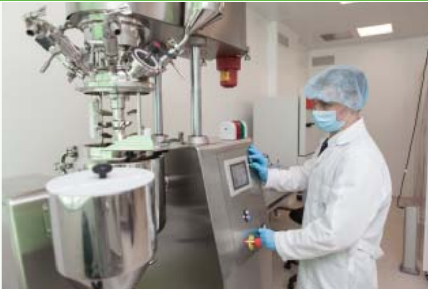
Турбоэмульсификатор AXOMIX для приготовления суппозиторной массы – производитель AXOMATIC S.r.l., Италия
