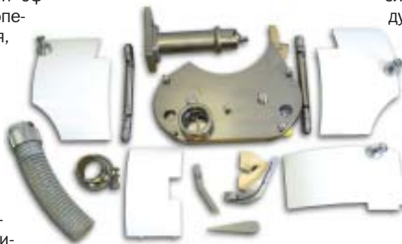
Рис. 2. Набор компонентов для быстрой смены форматов
