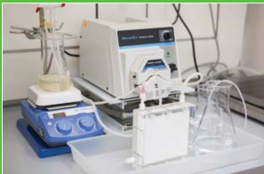
Ультрафильтрационная установка для фракционирования раствора по молекулярным массам смеси высокомолекулярных соединений
