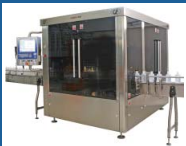
Инспекционная машина LYNX 100 для пластиковых флаконов
