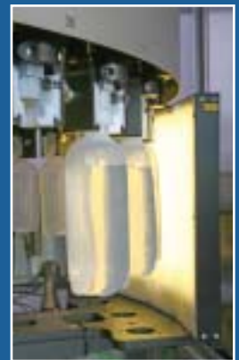
Просмотр BFS-контейнеров на одной из станций контроля инспекционной машины
