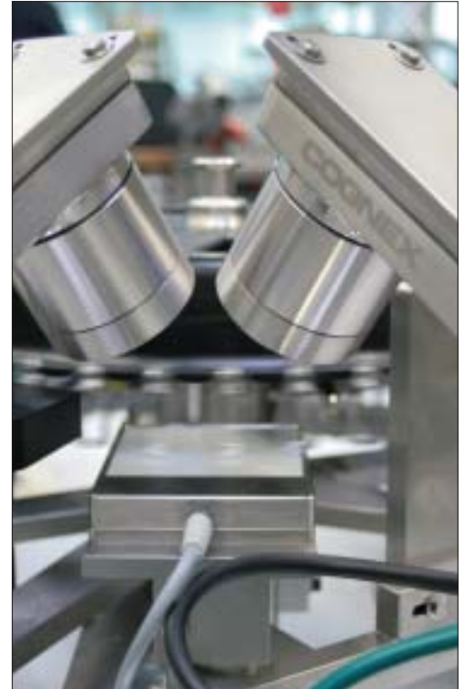
groninger UFV: станция проверки камерой
