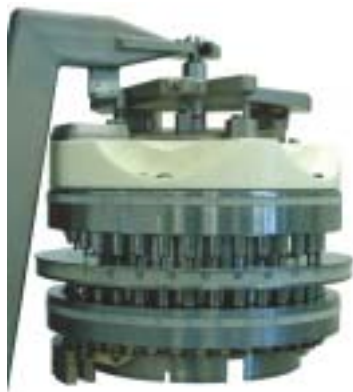
Рис. 3. Упрощенная замена ротора
