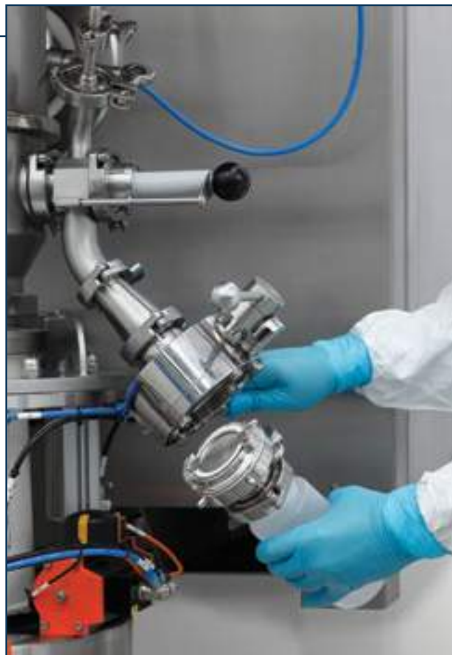
Рис. 4. Порт изолятора, размещенный под просеивающим блоком установки BRC, обеспечивает удобство выгрузки гранул
