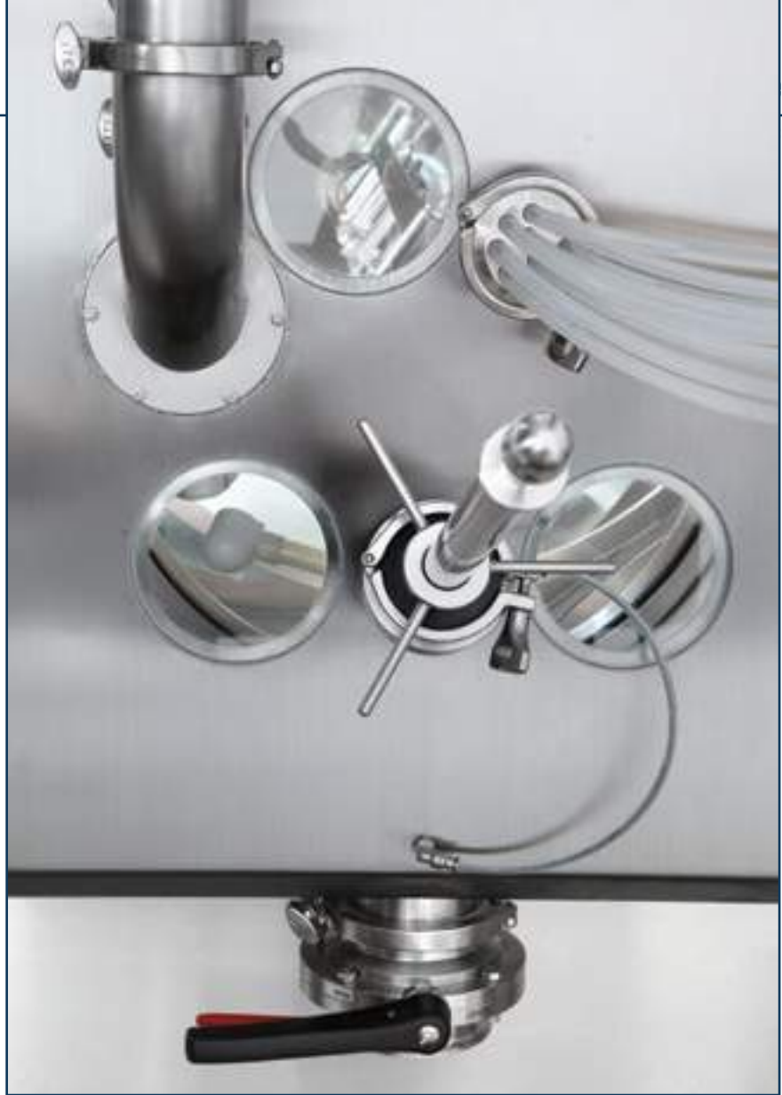
Рис. 2. Наличие пробоотборника в коатере BFC 100 обеспечивает возможность контроля продукта в ходе технологического процесса
