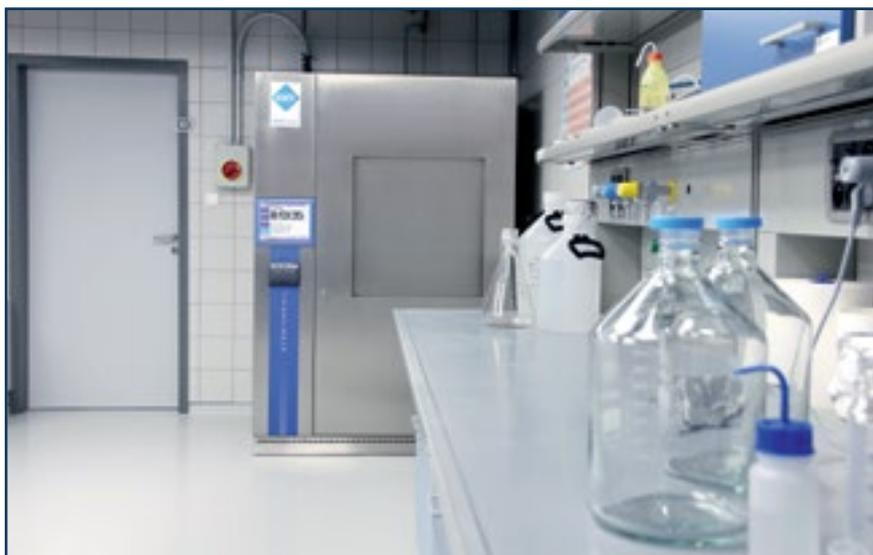
Рис. 8. Стерилизатор лабораторного класса на месте установки
