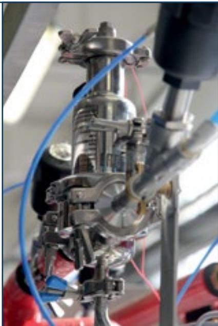
Рис. 6. Воздушный фильтр в стерилизаторах фармацевтического класса (GMP)
