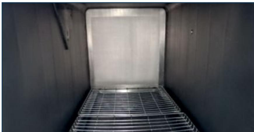
Рис. 2. Исполнение камеры в стерилизаторе фармацевтического класса (GMP)
