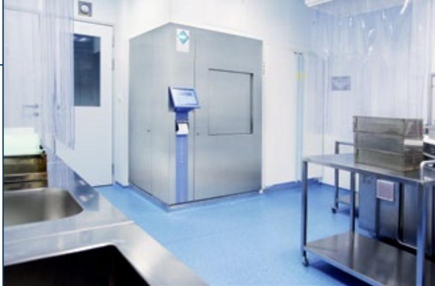
Рис. 7. Стерилизатор фармацевтического класса (GMP) на месте установки
