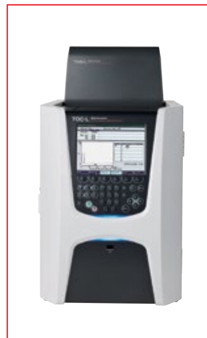
Фото № 2. Лабораторный ТОС-анализатор модели ТОС-LCSH в комплекте с блоком для определения общего связанного азота TNM-L
