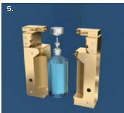
Описанные выше этапы выполняются в считанные секунды (12 – 18 с в зависимости от конфигурации флакона / емкости и рабочего объема), что является решающим аргументом в пользу использования технологии BFS при асептическом производстве. Короткий рабочий цикл, розлив и запайка в асептических условиях без участия человека – это те причины, по ко-
