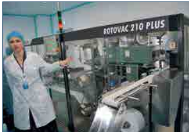
Блистерная упаковочная машина Rotovac 210 PLUS от компании IMA Spa
