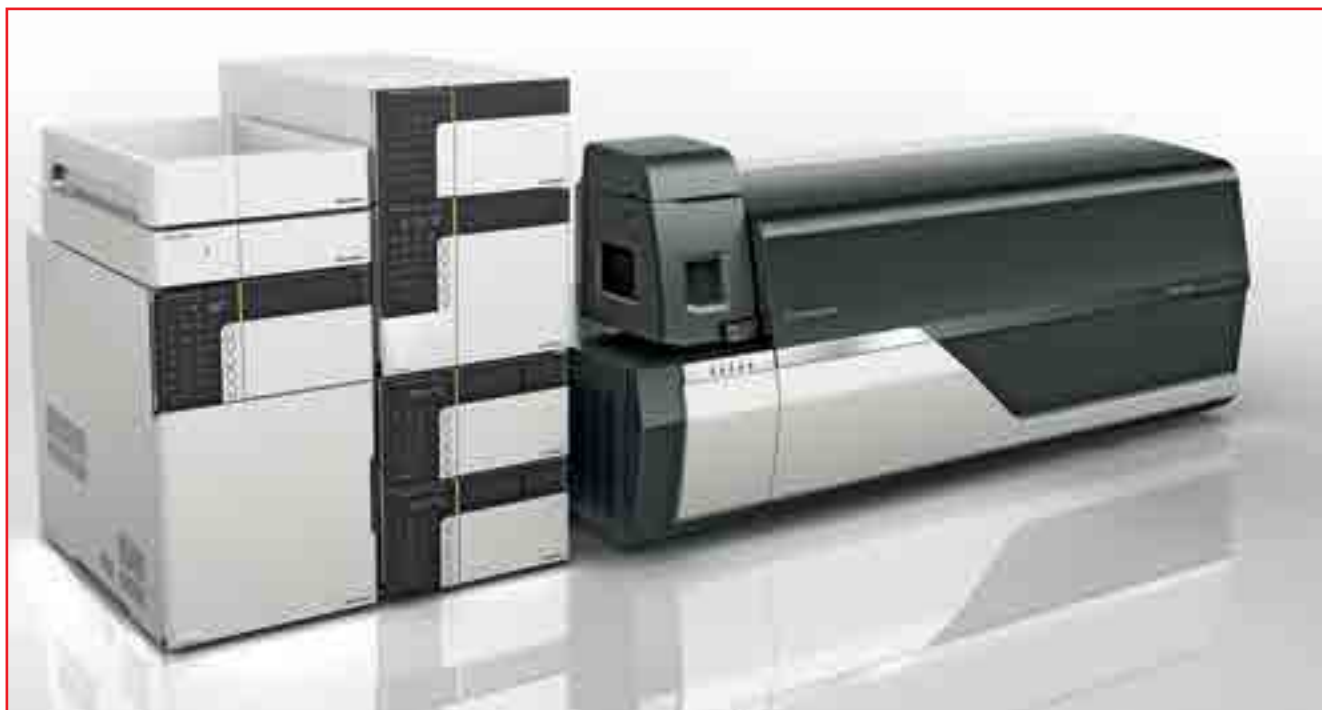
Фото № 2. Трехквадрупольный жидкостный хромато-масс-спектрометр модели LCMS-8050
