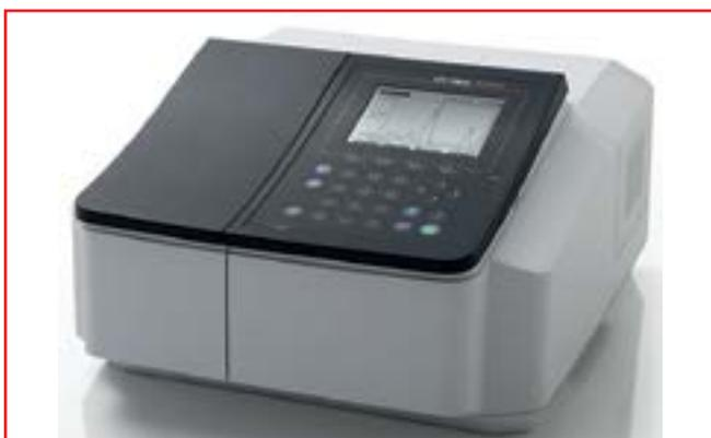
Фото № 1. Спектрофотометр УФ-видимого диапазона модели UV-1800
