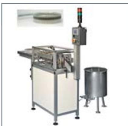
**Полуавтоматическая установка для фасовки жидких продуктов в монодозы производства компании Valmatic s.r.l. (Италия)**
