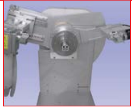
Фото № 3. Вертикальный гониометр \theta - 2\theta типа для рентгеновского дифрактометра модели XRD-7000 «Maxima_X»
