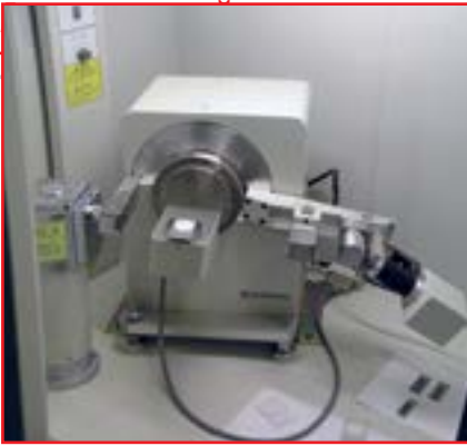
Фото № 2. Вертикальный гониометр \theta - 2\theta типа для рентгеновского дифрактометра модели XRD-6100 «LabX»
