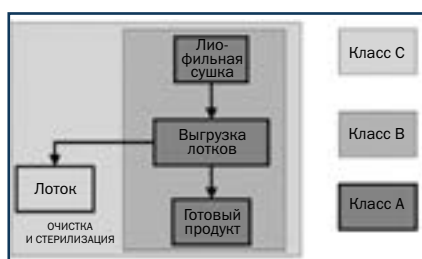
Рис. 2. Выгрузка стерильного лиофилизированного продукта
