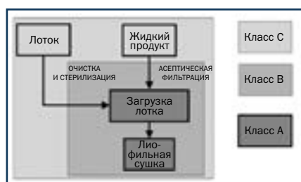
Рис. 1. Процесс асептической загрузки стерильного лиофилируемого продукта
