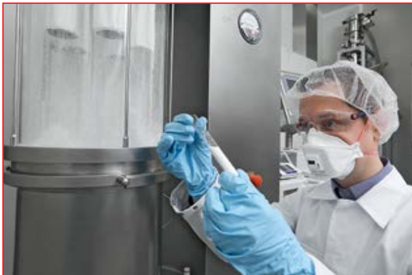
Установка Xelum R&D для непрерывного производства твердых лекарственных форм для перорального применения
