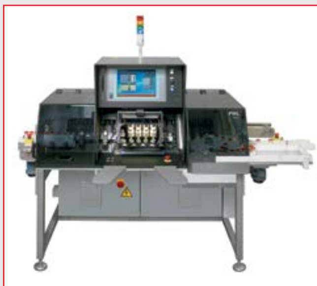
Серия PWL – полуавтоматическая инспекционная линия для широкого спектра применений
