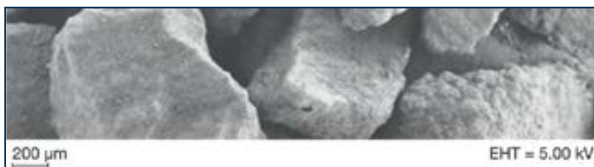
Рис. 1. Изображение РЭМ Ибупрофена DC 85 W (вторичная электронная эмиссия, 5 кВ, 12 нмРт)
