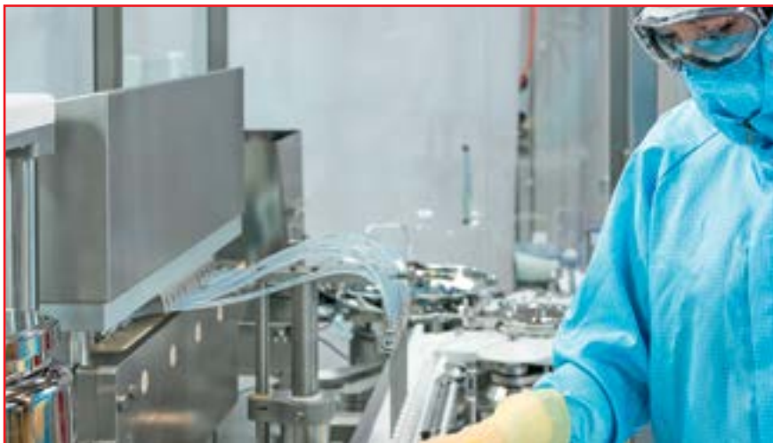
Универсальная фасовочно-упаковочная машина ALF 5000 для ампул, флаконов или контейнеров обоих типов
