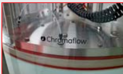
Рис. 1. Колонка Chromaflow™, 2000 мм i.d.
