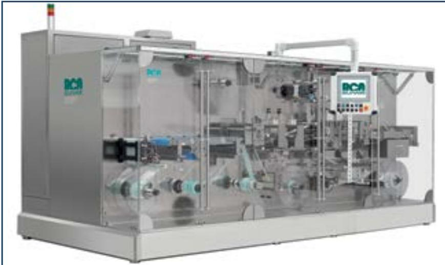
Оборудование для производства ODF
