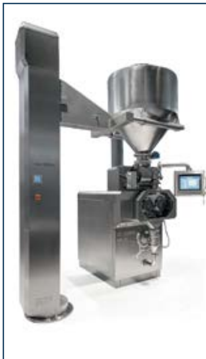
Рис. 2. Для установки новой подъемной колонны HS SL необходима поверхность площадью всего 0,3 м 2
