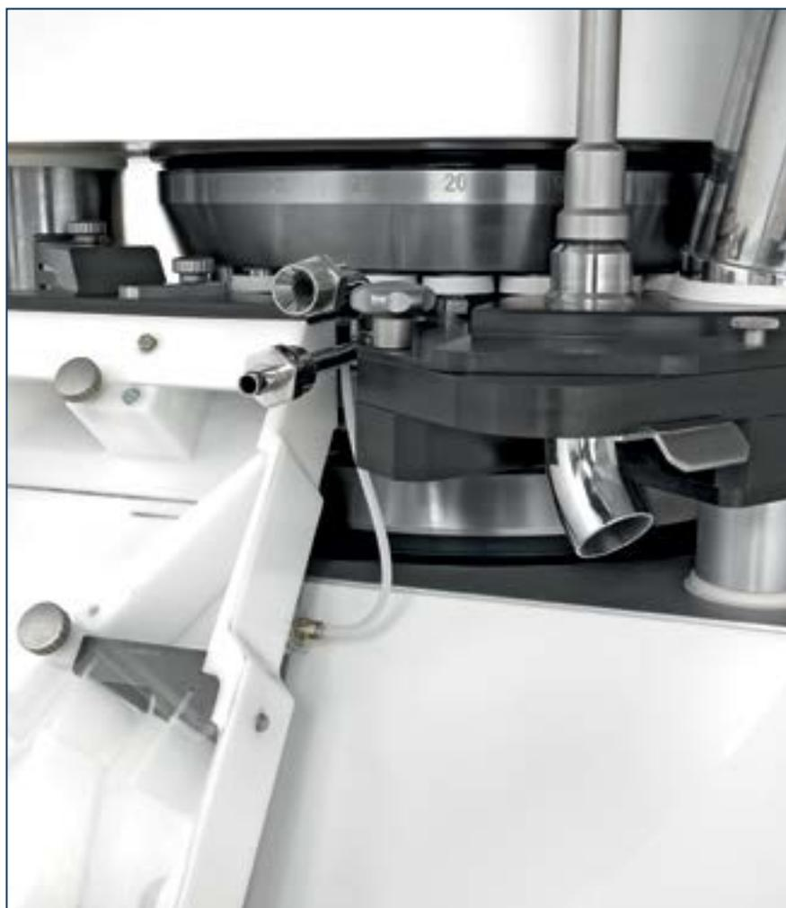
Фрагмент пресса модели IMA PREXIMA, оснащенного для подключения к системе LUMS
