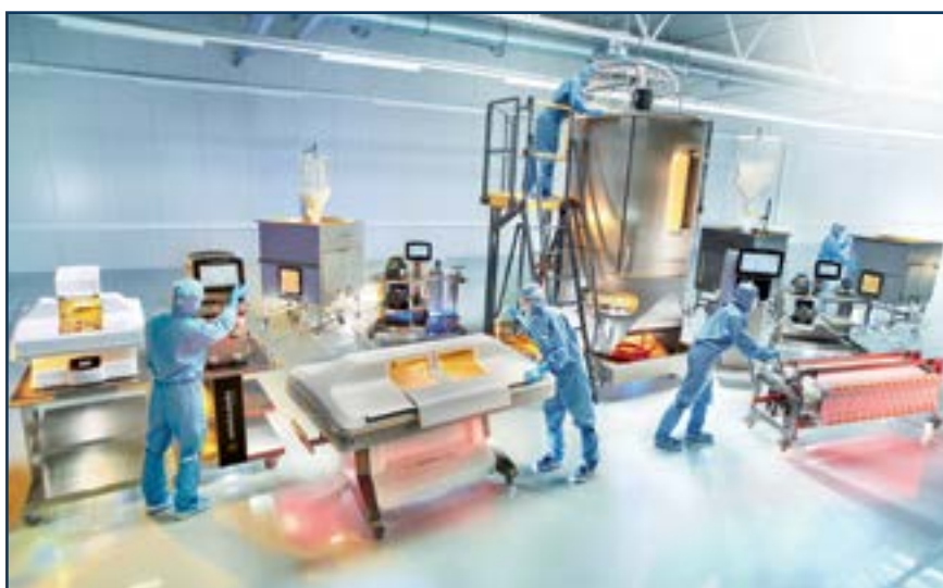
Рис. 1. Оборудование одноразового применения может включать в себя предварительно стерилизованные одноразовые мешки, трубки, фитинги и соединительные элементы. Также существует возможность применения биореакторов объемом до 2000 л для процессов культивирования клеток с использованием исключительно одноразовых компонентов
