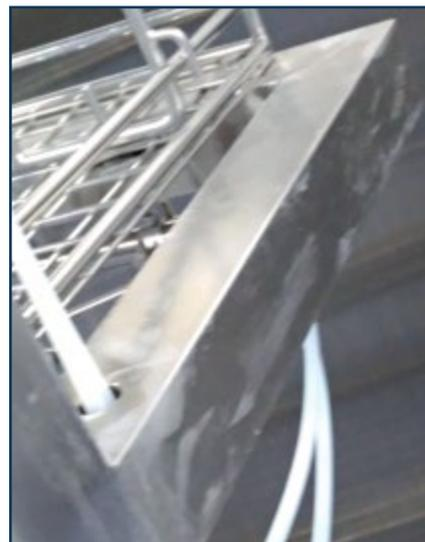
Рис. 3. Пример реакции детергента с питьевой водой при отмывке деталей в моечной машине
