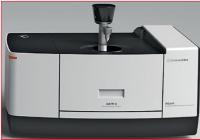
Фото № 4. Приставка НПВО модели QATR-S с ИК-спектрометром модели IR Spirit
