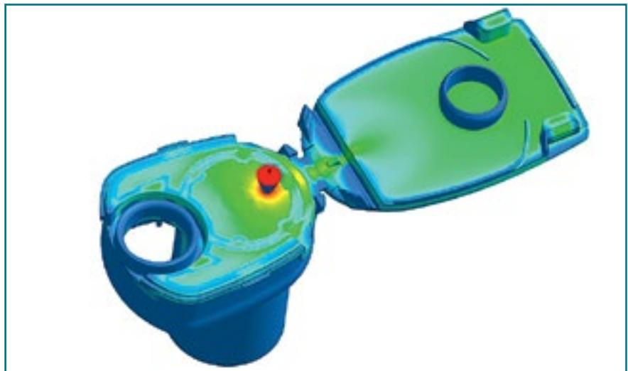
Рис. 2. Анализ заполнения материалом формы, близкой к промышленному образцу
