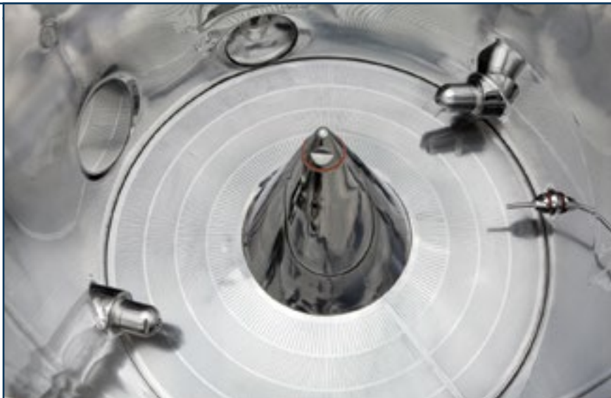
Рис. 2. Система Bohle Uni Cone BUC® с тангенциально установленными распылительными головками (внутри аппарата BFS 30)
