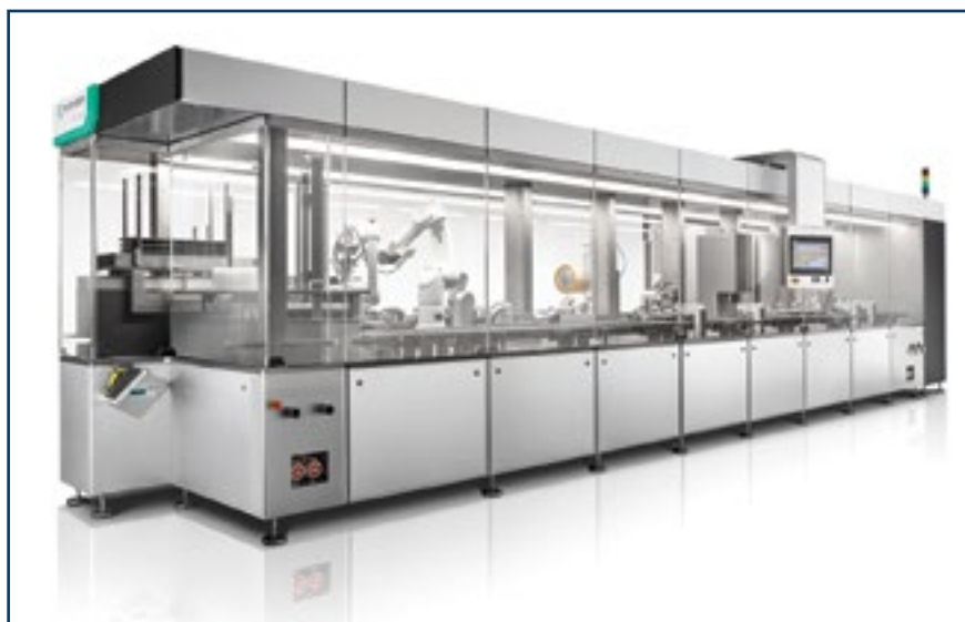
Рис. 1. Машина MC 1400 для наполнения и запайки с асинхронной транспортной системой в исполнении высокой очищаемости от ДНК
