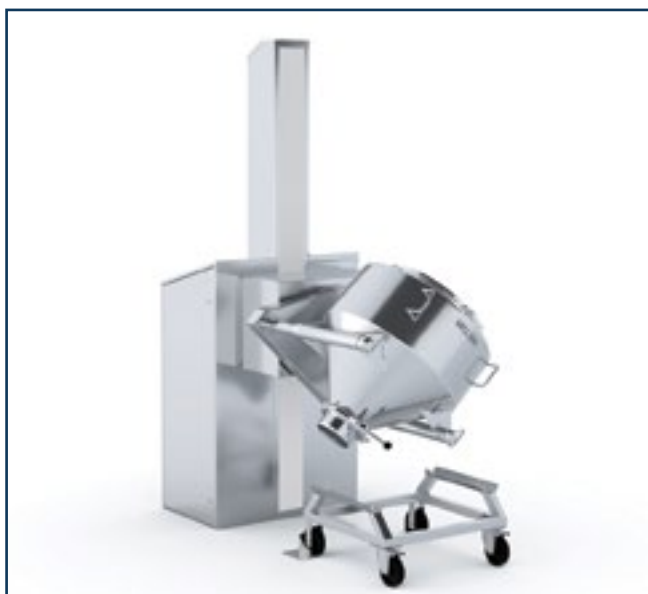
Рис. 1. Смеситель PM 400 с контейнером MCL 300, который был установлен на предприятии российского заказчика в начале этого года
