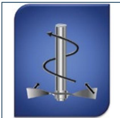
Такое движение лопасти сопровождается мягким механическим воздействием на движение частиц порошкового материала, что позволяет оценить уровень механического сцепления и трения между частицами. Все измерения проводили трижды.
