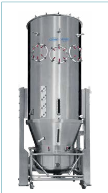
Гранулятор псевдооживленного слоя VNC-300
