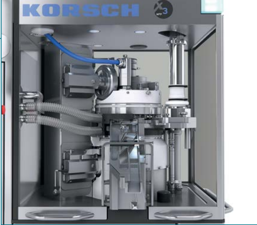
На задней стороне машины находится multifункциональная колонна, в которой имеется два отделения, где расположены электрические компоненты и основные соединения для пылеудаления
