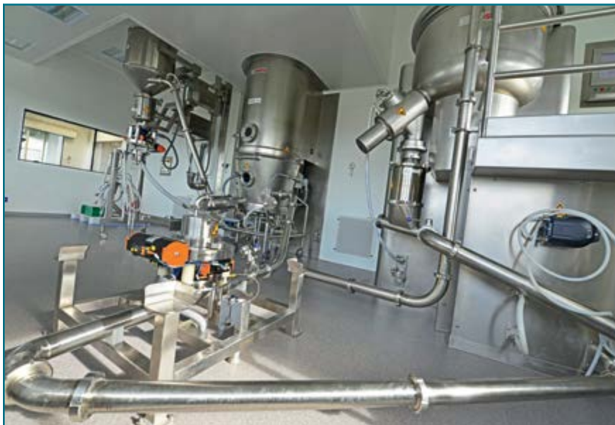
Установка производителя ветеринарных фармацевтических препаратов Vétoquinol состоит из смесителя с высоким усилием сдвига с мешалкой «Gentlewing», псевдооживленного слоя и рециркуляционной системы очистки в системе герметизации на основе разъемных делительных клапанов
