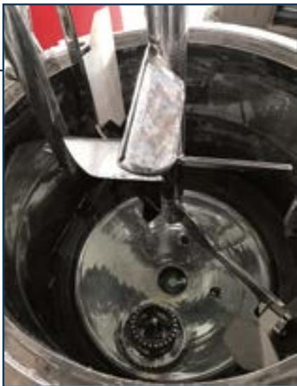
Рис. 2. Система медленного перемешивания с верхним креплением, лопастями и фиксированными буферами, оснащенная датчиками температуры, которые распределены внутри на разных уровнях, и донным эмульсатором
