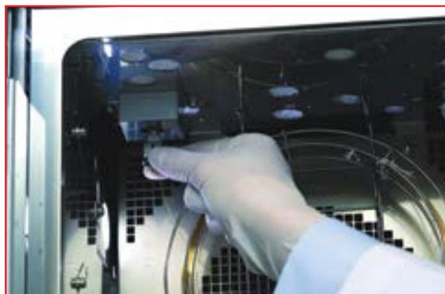
Фото № 2. Замена колонки с помощью устройства по технологии ClickTec на хроматографе GC-2030
