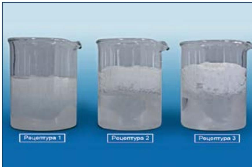
Рис. 5. Слой альгинатного геля в 0,1 М HCl без CaCO<sub>3</sub> с обычной концентрацией CaCO<sub>3</sub> и двукратно повышенной концентрацией CaCO<sub>3</sub>
