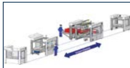
Рама машины и корпус шкафа управления из стали покрыты порошковой краской, дверцы шкафа управления и передние панели в видимой области выполнены из матовой нержавеющей стали. Шкафы управления машины интегрированы как в верхнюю, так и в нижнюю часть рамы модуля. Кабели и шланги, как правило, спрятаны внутрь рамы.
