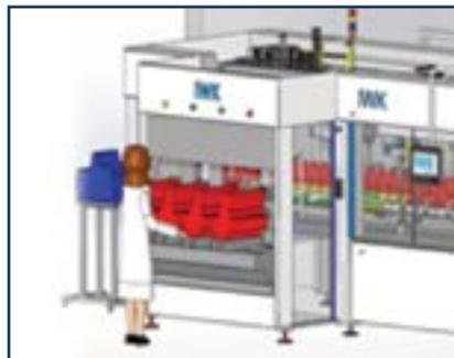
Три накопителя для сложенных выкроек пенала, которые оператор загружает вертикально в накопители. Сложенные выкройки пеналов захватываются и перемещаются на станцию формовки, где происходит их формовка и размещение на транспортные спутники.
