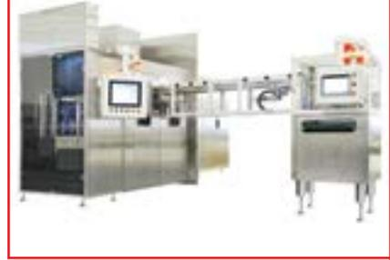
Линия формирования (выдува – наполнения-запайки (BFS)) пластиковых ампул и флаконов для инфузионных растворов
