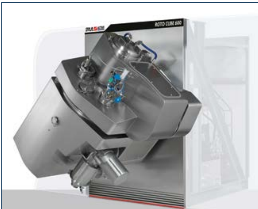
Установка ROTO CUBE 600 для получения шипучих гранул ацетилцистеина методом однокамерного гранулирования
