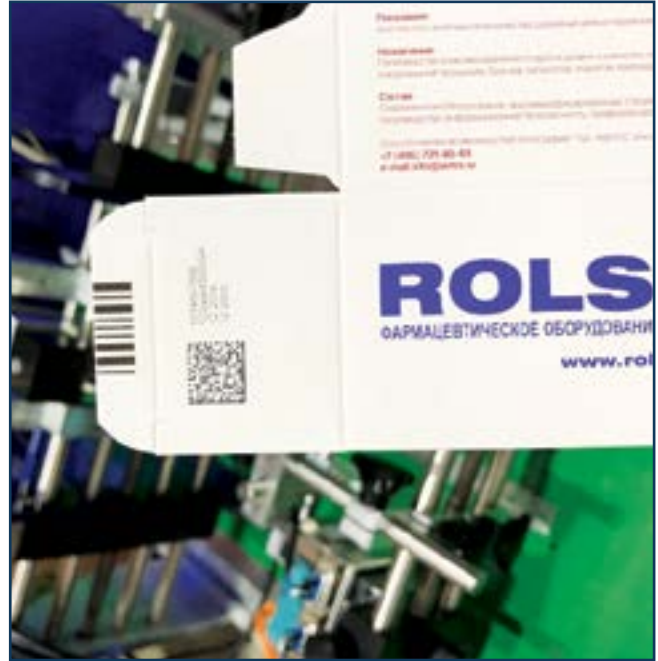
Нанесение переменных данных и кодов на сложные пачки на новом листателе ROLS-210
