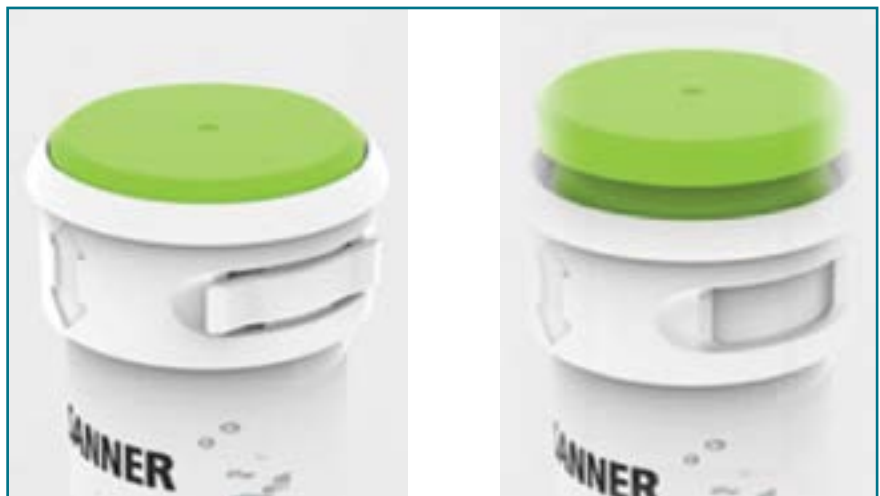
Пример механизма открывания Push-up-Pull-down, в котором замок освобождается для открытия после того, как предохранительное кольцо было перемещено вверх, а затем обратно в исходное положение
