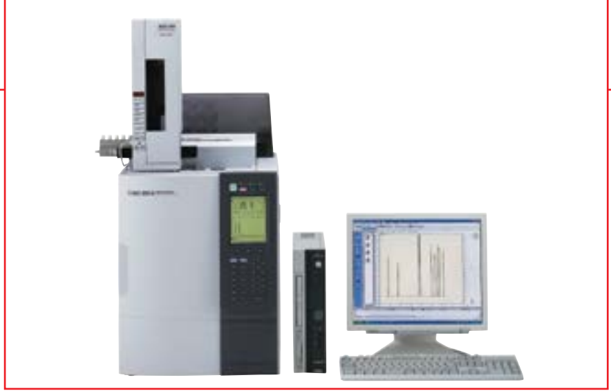
Фото № 4. Газовый хроматограф модели GC-2014 с автоинжектором AOC-20i
