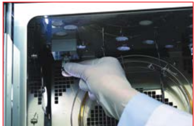
Фото № 2. Замена колонки с помощью устройства по технологии ClickTec на хроматографе GC-2030
