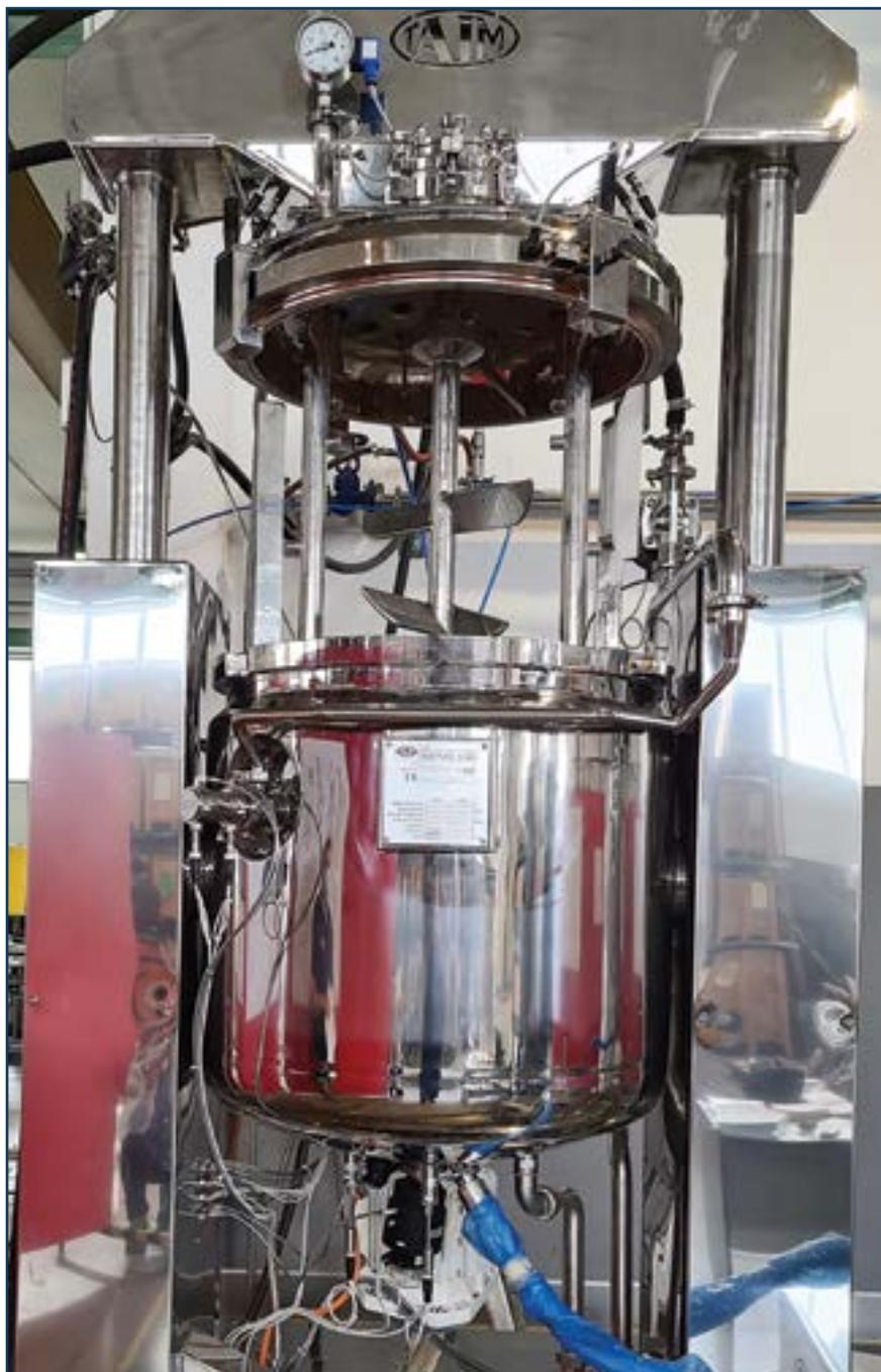
Рис. 1. Турбозмульсатор-стерилизатор TD-300 Turbo для изготовления партии продукции объемом 300 л
