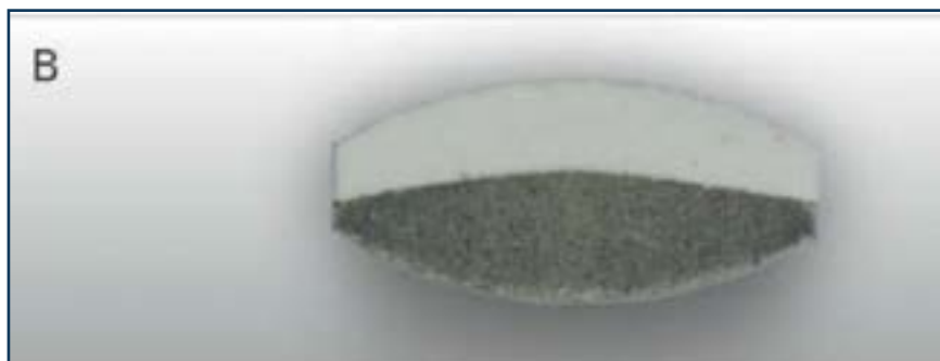
Рис. 2В. Чрезмерная сила прессования приводит к выпуклой линии разделения между слоями. Верхний слой состоит из состава D, нижний – из состава S
