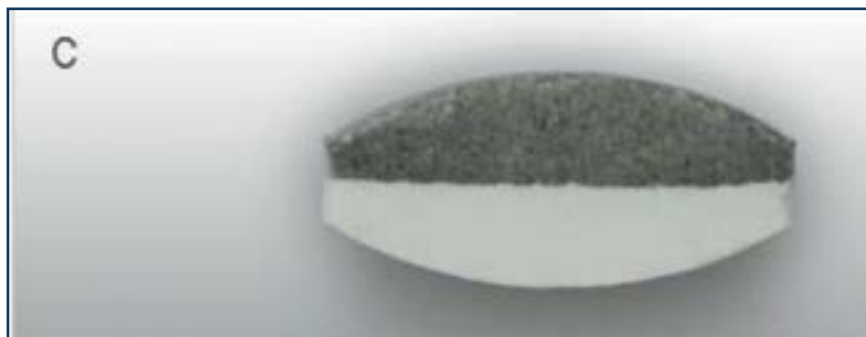
Рис. 2С. Надлежащая сила прессования приводит к горизонтальной линии разделения между слоями. Верхний слой состоит из состава S, нижний – из состава D
