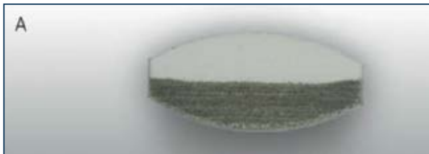
Рис. 2А. Надлежащая сила прессования приводит к горизонтальной линии разделения между слоями. Верхний слой состоит из состава D, нижний – из состава S
