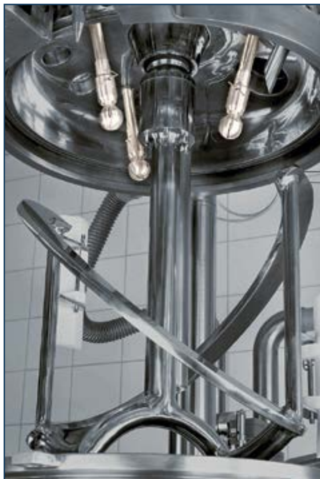
Рис. 3. Безразборная мойка (CIP) с вращающимися мощными головками внутри смесителя
