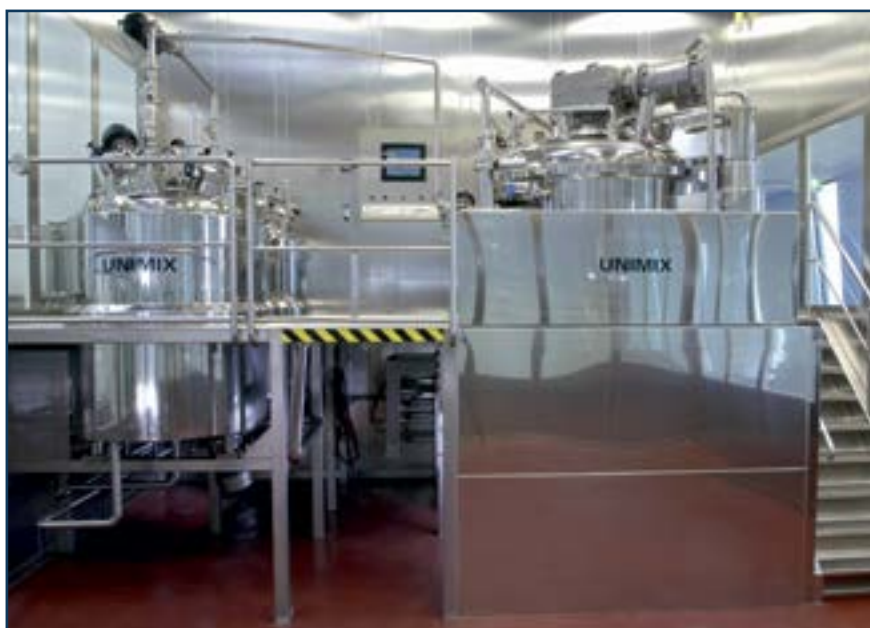
Рис. 1. Вакуумная установка UNIMIX SRC соответствует всем требованиям GMP
