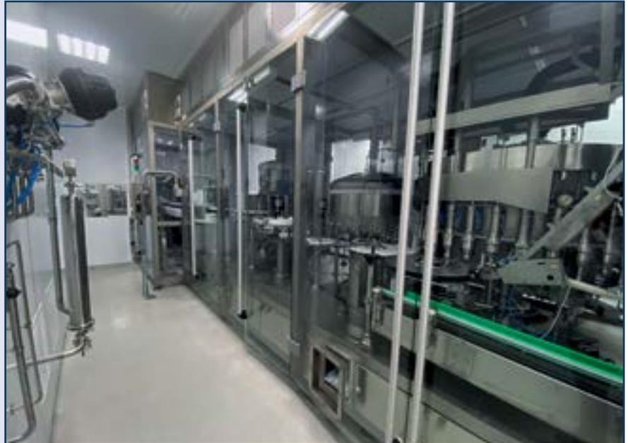
Машина розлива ISBM производства компании GF S.p.A. для наполнения емкостей большого объема растворами для парентерального введения
