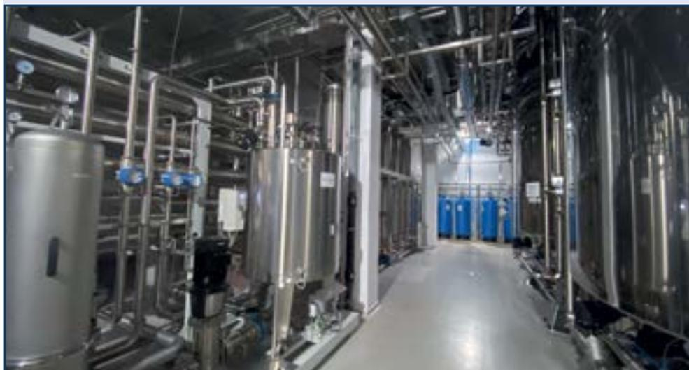
Новый производственный комплекс оснащен системой двухступенчатого обратного осмоса STILMAS BRO 424/PHRO 360 и дистиллятором STILMAS MS 4007 HPS для получения воды для инъекций (ВДИ)
