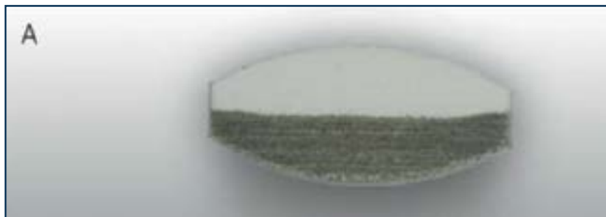
Рис. 2А. Надлежащая сила прессования приводит к горизонтальной линии разделения между слоями. Верхний слой состоит из состава D, нижний – из состава S
