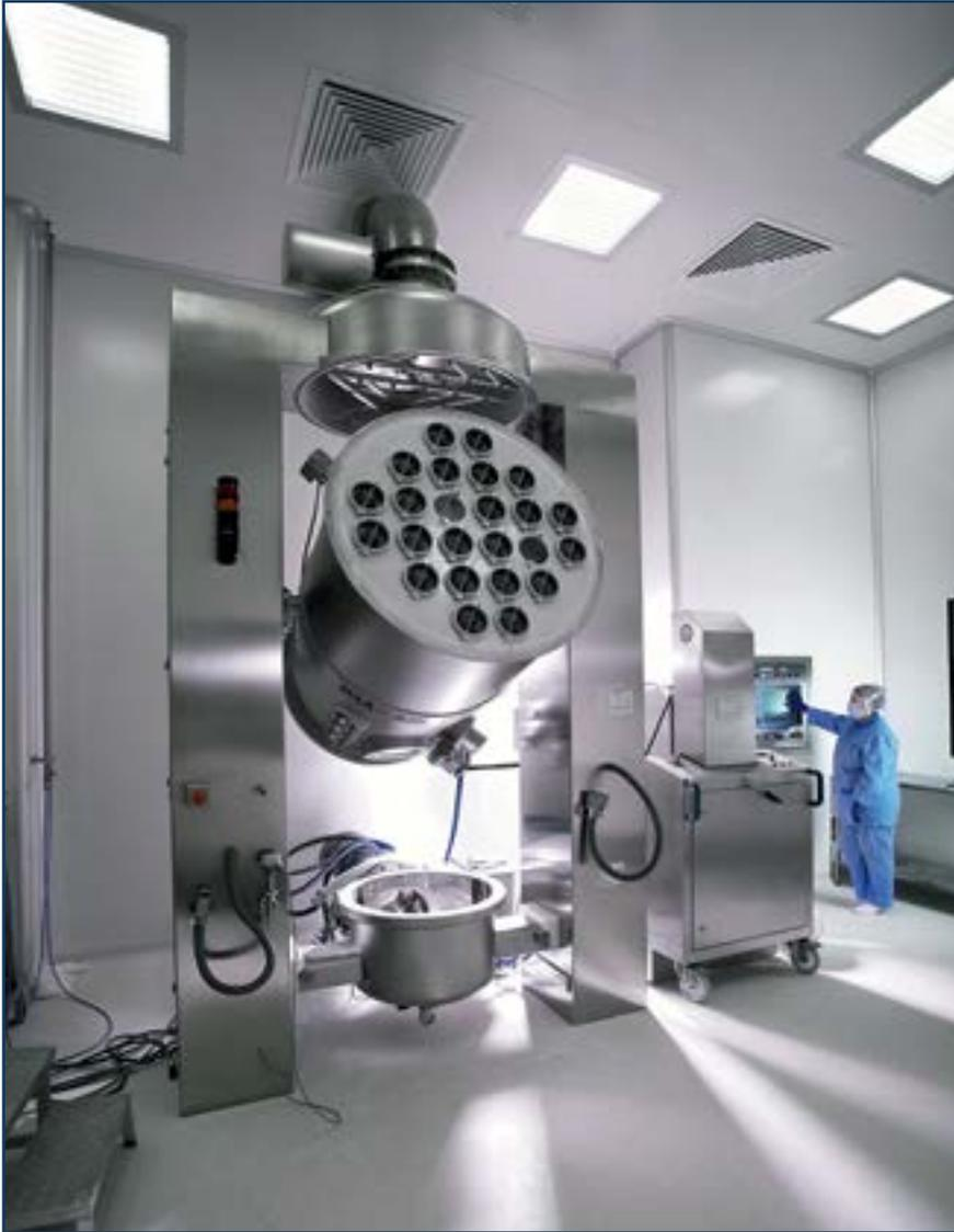
положительно отразилось на производственном процессе: помогло избежать окончательного отскобливания чаши после разгрузки продукта, так как проблема его прилипания к внутренним боковым стенкам была успешно решена.
