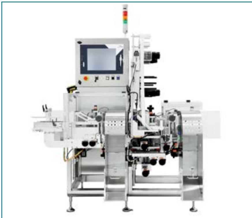
Комбинированная установка – нанесение, верификация, отбраковка. Может быть добавлен модуль весового контроля и/или контроля первого вскрытия
