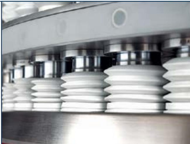
Конические матрицы с нижним ободком для работы при повышенных усилиях выталкивания
