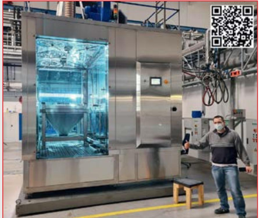
Рис. 3. Система очистки контейнеров модели PH 880.2
