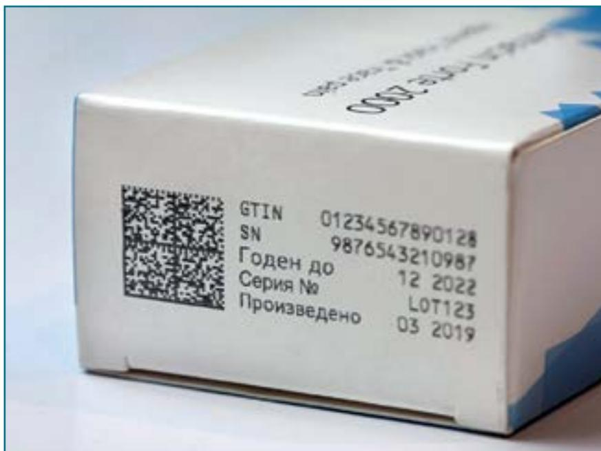
Образец нанесения Data-matrix кода и текстовой информации
