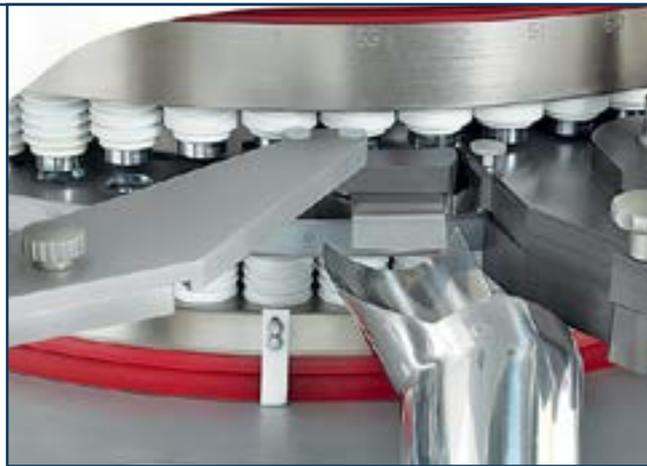
Модифицированная система выталкивания и выходной желоб для деликатного обращения с таблетками на выходе из машины
