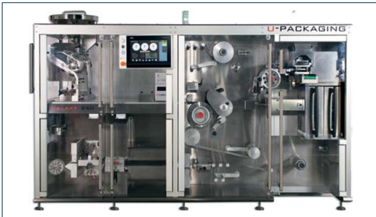
GALAXY 250: длина машины составляет менее 3 м, производительность – 250 блистеров в 1 мин
