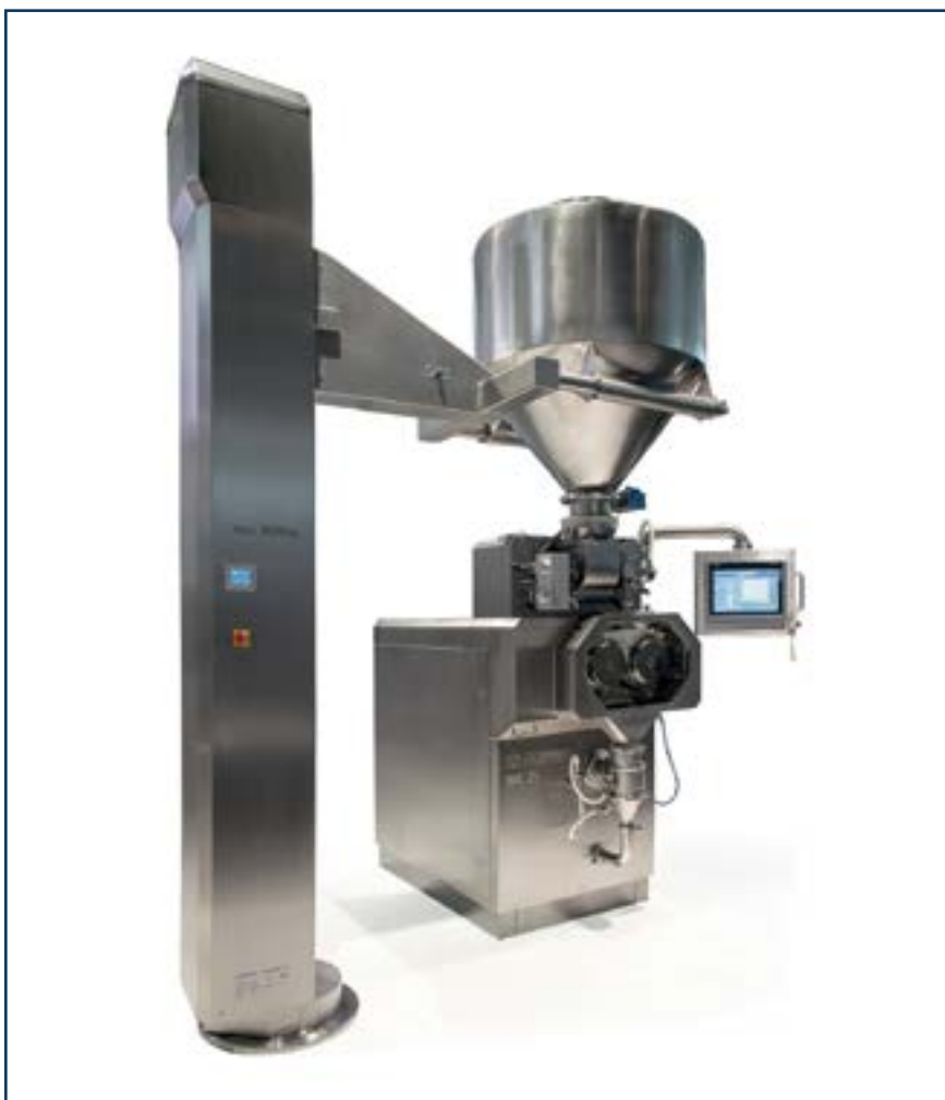
Рис. 4. Серия BRC, в этом примере в сочетании с подъемной колонной, гарантирует постоянные свойства полотна благодаря тому, что усилие создается исключительно электро-механическими средствами
