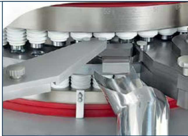
Модифицированная система выталкивания и выходной желоб для деликатного обращения с таблетками на выходе из машины
