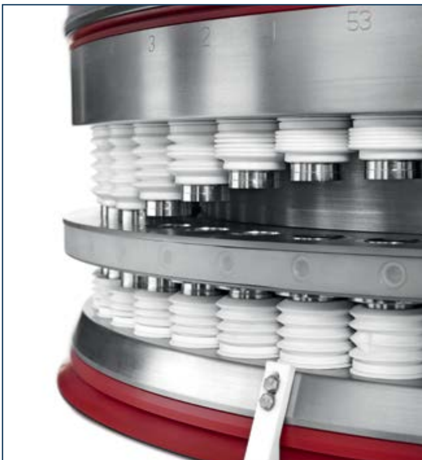
Контактирующие с продуктом детали турели изготовлены из специальных материалов
