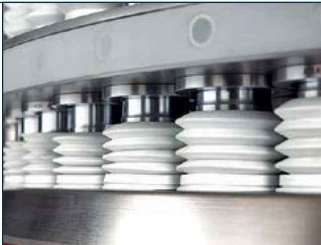
Конические матрицы с нижним ободком для работы при повышенных усилиях выталкивания
